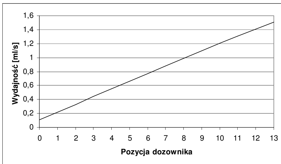
Wykres 1 - Wydajność dozownika płynu myjącego w funkcji nastawy pokrętkła regulacyjnego
