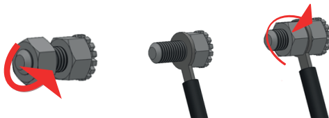
Obrázek č. 5. Připojení přístroje k zařízení pro vyrovnávání potenciálu.
