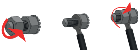
Figura 5. Conexión del equipo a una instalación equipotencial.
