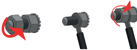
Fig. 5. Raccordement de l'appareil à une installation équipotentielle.
