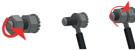
Bild 5. Der Anschluss des Gerätes an die Einrichtung zum Potentialausgleich
