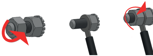
Rys. 5. Podłączenie urządzenia do instalacji wyrównującej potencjały elektryczne.
