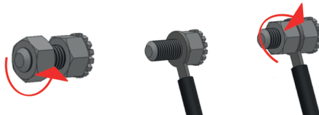
Bild 7. Der Anschluss des Gerätes an die Potentialausgleichsanlage
