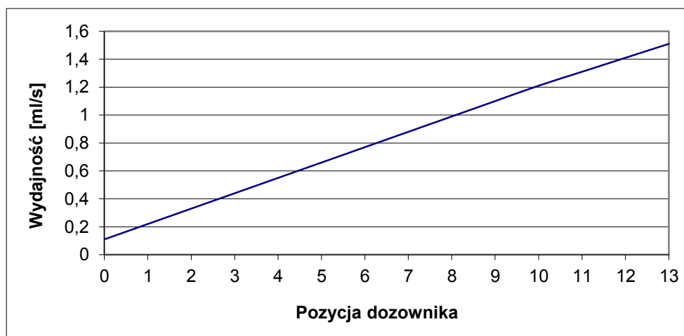
Wykres 1 - Wydajność dozownika płynu myjącego w funkcji nastawy pokrętła regulacyjnego
