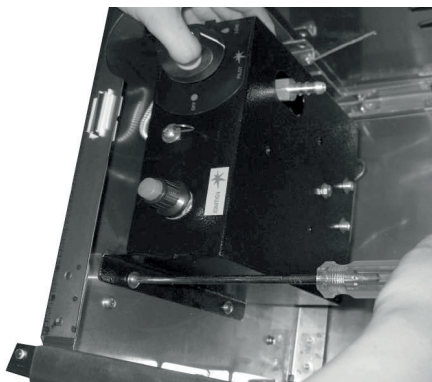
ΒΗΜΑ 2: Φροντίστε η δεξαμενή να κοιτάζει προς τα κάτω. Στερεώστε τον καυστήρα (J) στη δεξαμενή χρησιμοποιώντας τις 4 κλασικές βίδες και τις ροδέλες (BB).
