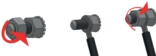
Podłączenie urządzenia do instalacji wyrównującej potencjały elektryczne.
