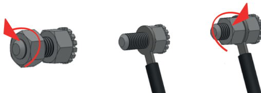
Figura 10. Conexión del equipo a una instalación equipotencial.
