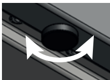
Rysunek 7. Poziomowanie urządzenia
