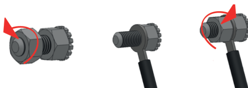
Obrázek č. 10. Připojení přístroje k zařízení pro vyrovnávání potenciálu.
