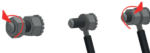
Figure 10. Branchement de l'appareil au dispositif équipotentiel
