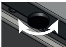
Figura 7. Nivelación del dispositivo
