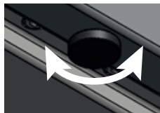
Bild 7. Ausnivellieren des Gerätes
