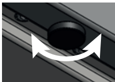
Obrázek č. 7. Vyrovnávání zařízení
