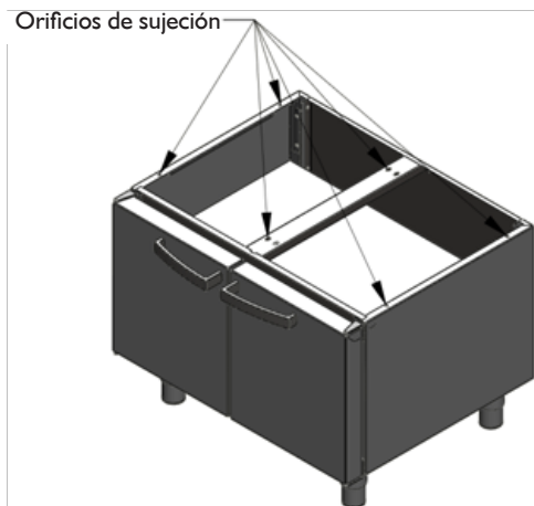
Figura 6. Base de apoyo con puertas (9703400) con orificios indicativos para atornillar un elemento de apoyo ajustable. En el resto de las bases los orificios están situados de forma análoga.
