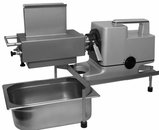
Rys.9. Podstawka P1000 w zestawie z napędem EM10 i stekerem.
