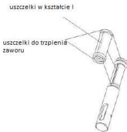
montaż prętów typu "I"
