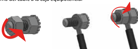
Conexión del equipo a una instalación equipotencial.
