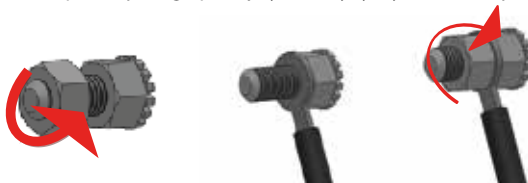
Podłączenie urządzenia do instalacji wyrównującej potencjały elektryczne.
