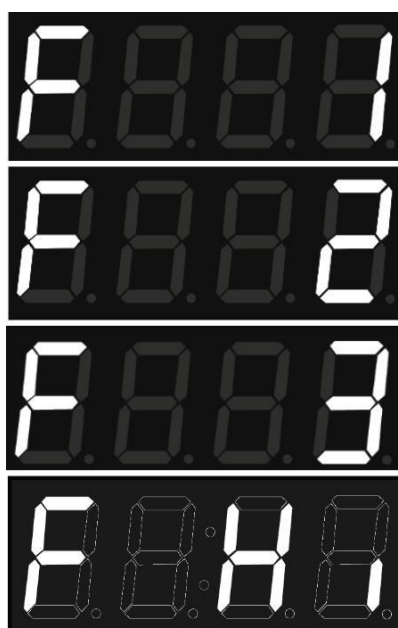
Rysunek 24. Dostępne 4 prędkości: 1, 2, 3 i maksymalna (HI) dla COMPACT MASTER
