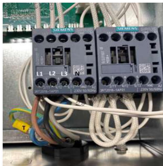
Rysunek 3. Podłączenie trójfazowe 400V 3L+N
