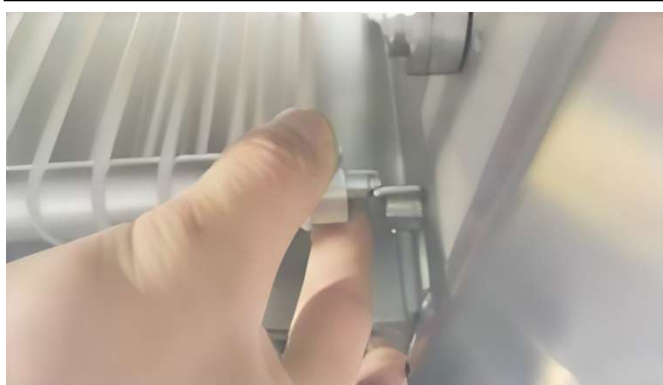
Przesuń taśmę w lewo. Unieś wałek do góry, aby go wyjąć
