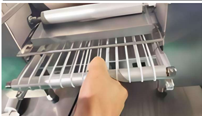
Odłącz przednią część taśmy, wyciągając wałek przesuwając go w prawo i unosząc go do góry
