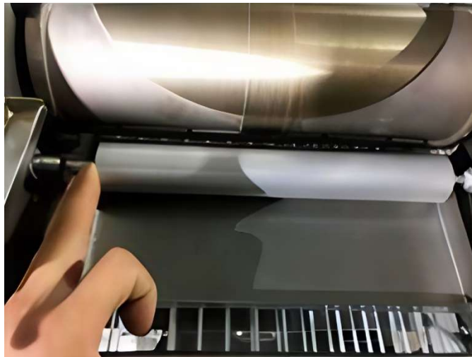
Przesuń wałek w prawo jedną ręką, złap go drugą ręką, unieś do góry i wyjmij z tacy
