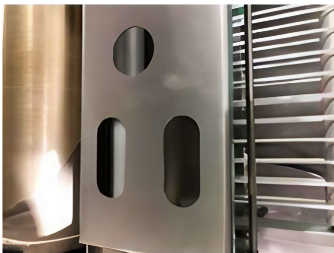
Wyjmij osłonę bębna, unosząc ją do góry
