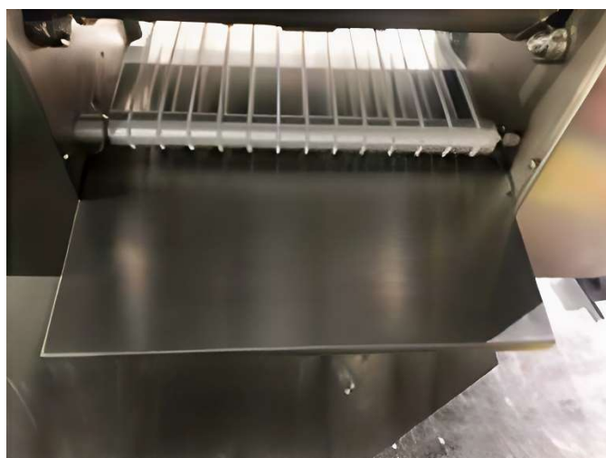
Wyciągnij tackę na resztki, wysuwając ją na zewnątrz
