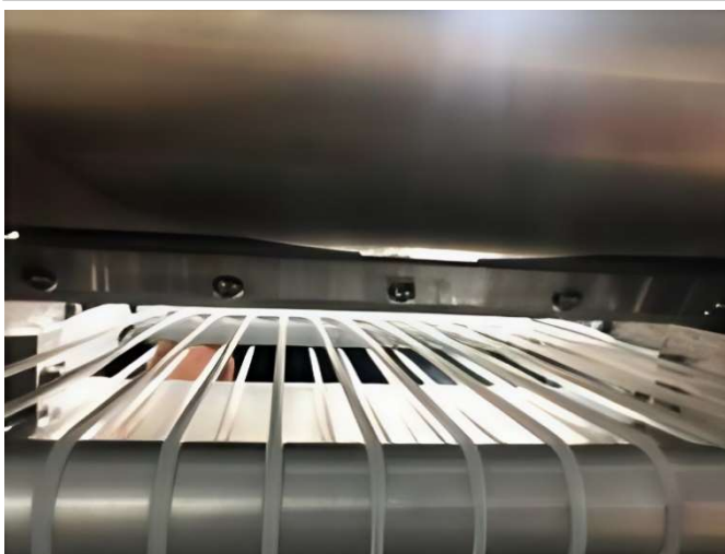
Wyczyść ostrze za pomocą długiego skrobaka silikonowego, usuwając pozostałości z powierzchni
