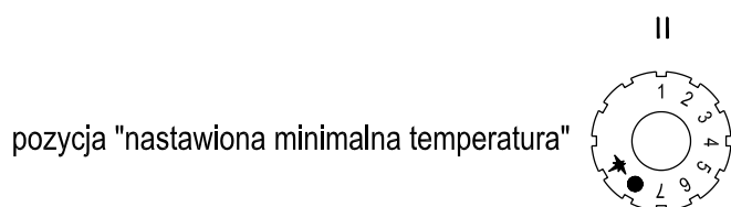
Rysunek 5 - Pokrętko zaworu gazowego EUROSIT 630 z zapalaczem piezoelektrycznym
